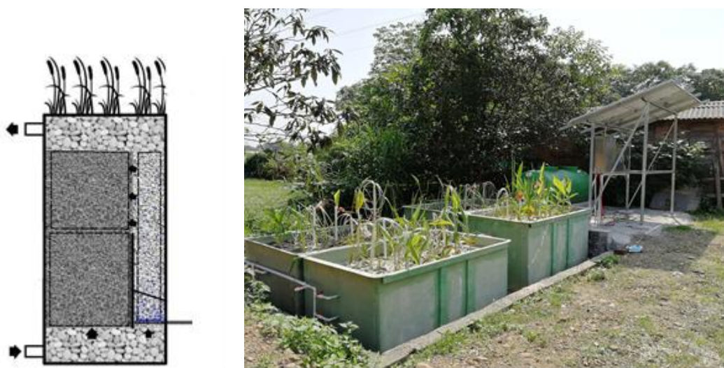
图3 微生物产电自传导生态净化技术及尧山养猪场养殖废水生态处理应用
