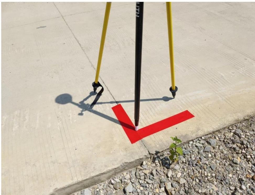
图B.4 直角型像片控制点标识示例图
