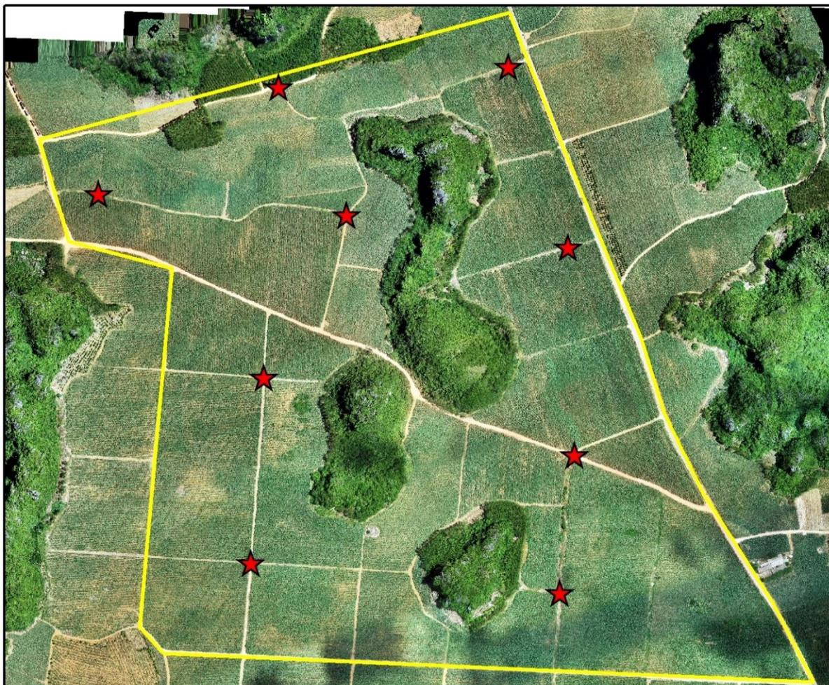
图B.2 不规则航摄区像片控制点布置示例图
