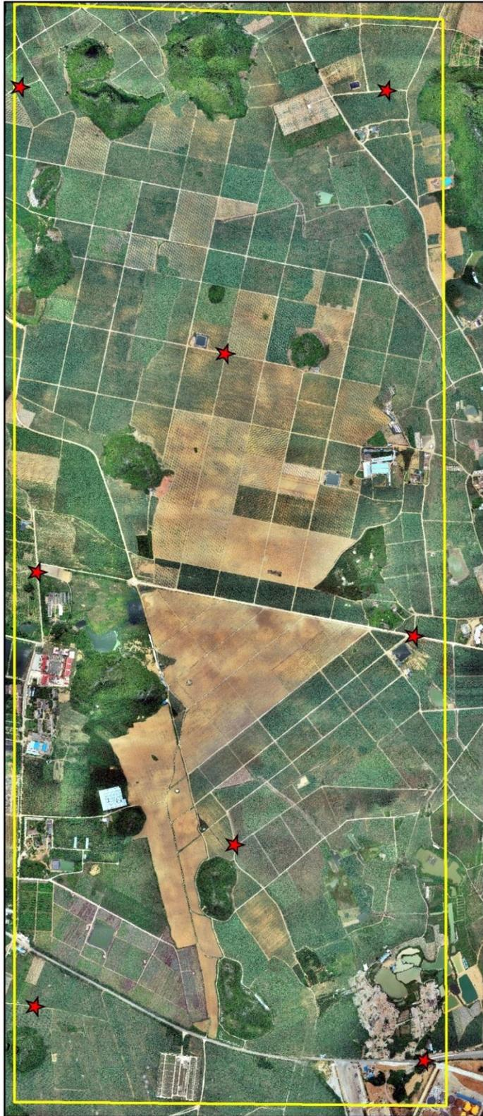
图B.3 带状航摄区像片控制点布置示例图
