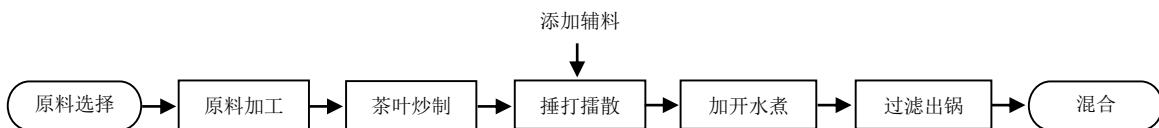
图1 南丹油茶传统制作工艺流程图
